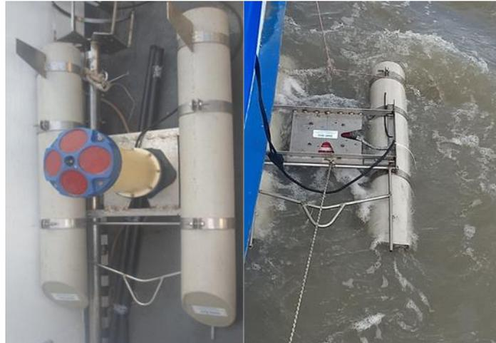
Figura 5: Perfilador acústico (ADCP) da RDI Instruments montado em catamarã.
