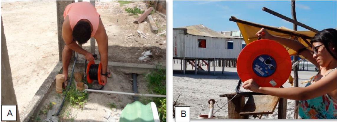
Figura 4.2: Mensuração do nível do nível freático em poço de abastecimento mediante utilização do medidor eletrônico.
