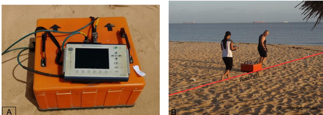
Figura 4.1: Operações de Campo. A) Aparelho GPR utilizado nos levantamentos; B) Perfil de GPR realizado na praia do Farol.
